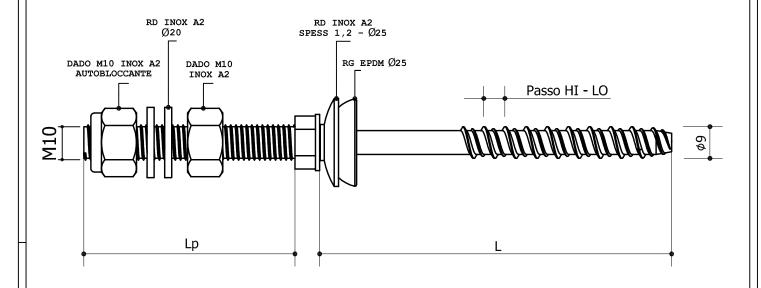
Tabella Tecnica sistema di fissaggio per pannelli fotovoltaici su cls
