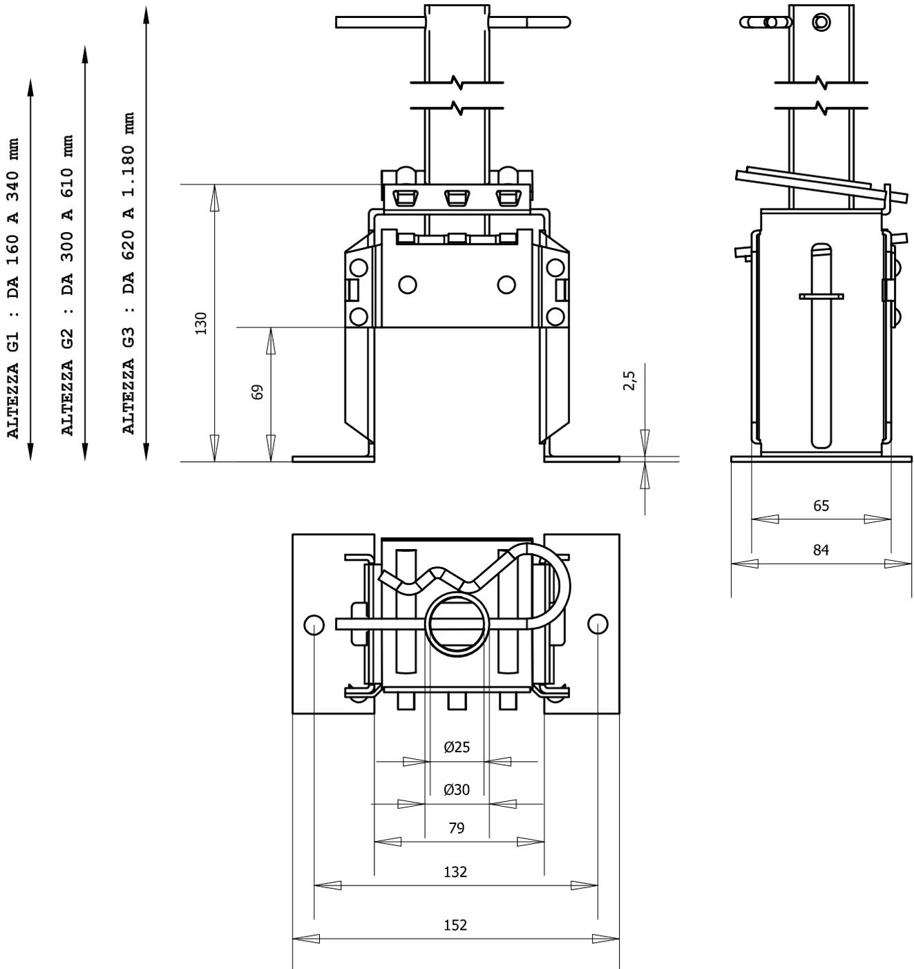
**MATERIALE BASE:** Telaio in lamiera di acciaio sagomata
