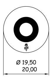
MATERIALE RONDELLA: Acciaio INOX AISI 304 SCALA: 2:1
